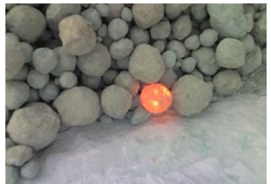
Figure 1. Mâchefer métallurgique à la sortie du four. Source : [11]
